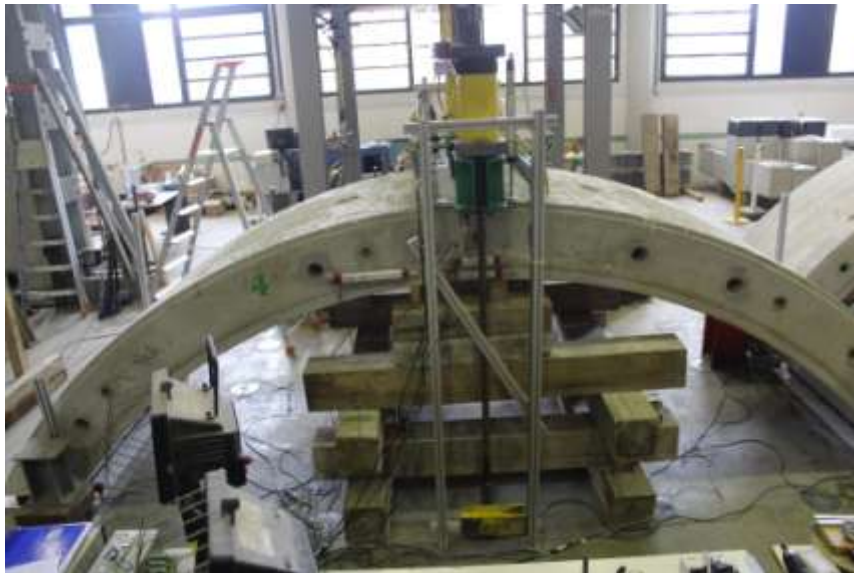
Flexión (carga lineal distribuida)
