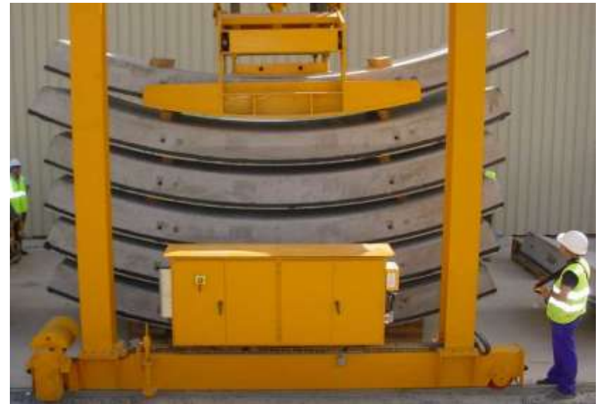
Flexión (acopio dovelas – excentricidad)
